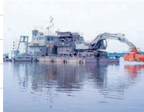
ウォーターリフレッシャーⅠ号 (密閉型グラブバケット搭載浚渫船)
