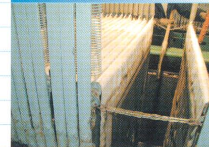
高圧フィルタープレスによって、浚渫土を脱水処理します。
