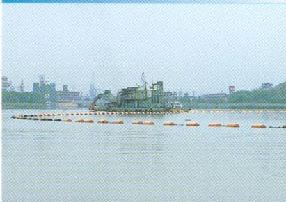
浚渫船からプラントヤードまで、長距離圧送します。
